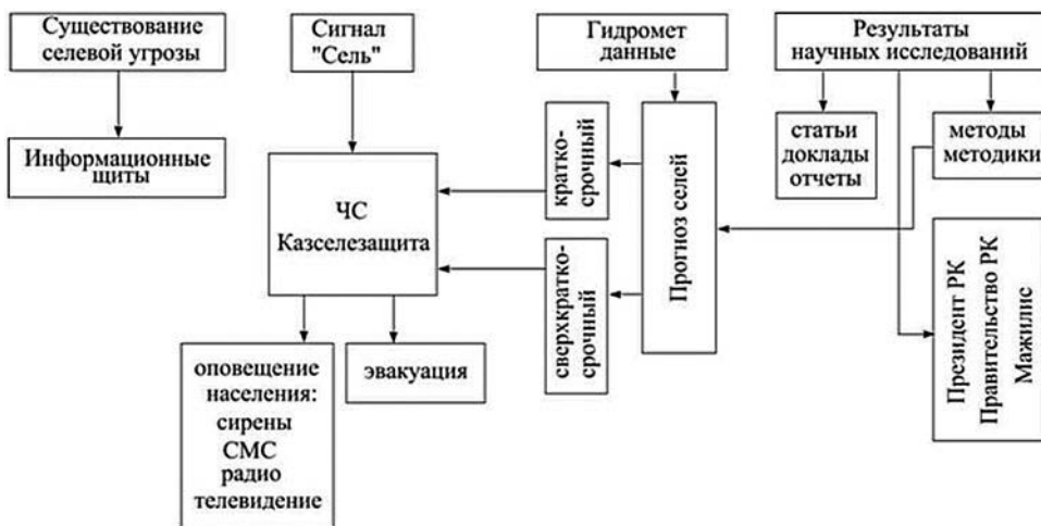
Рисунок 4.22 – Структура системы оповещения о селевой угрозе
