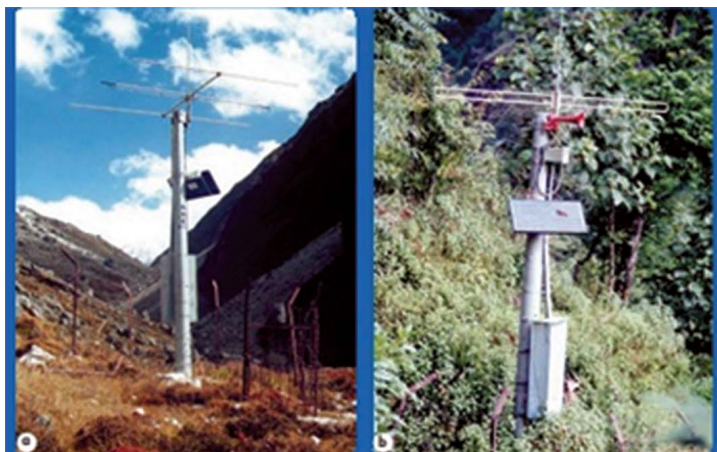
Рисунок 1.1 – Система раннего оповещения о сходе селя в долине Тамакоши:
