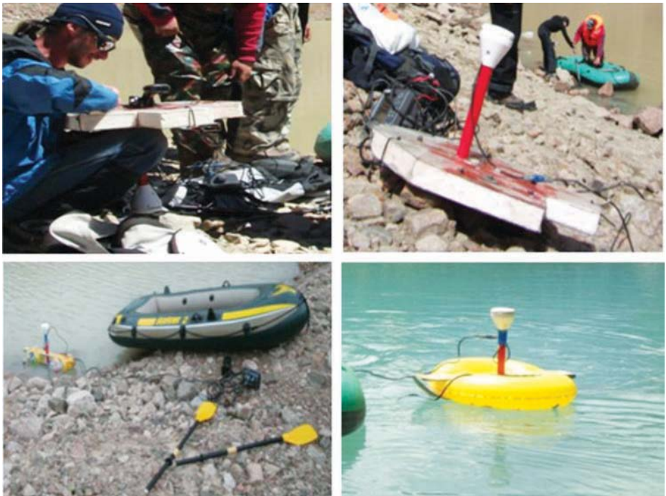
Рисунок 4.4 – Варианты крепления эхолота и GPS приемника
