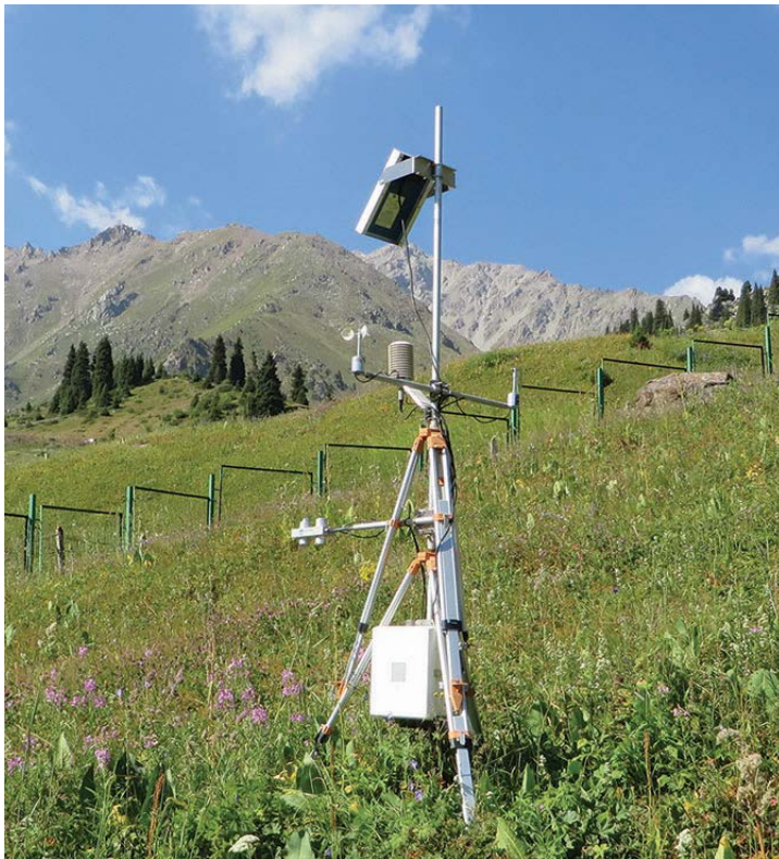
Рисунок 4.24 – Автоматическая метеостанция Campbell Scientific производства США
