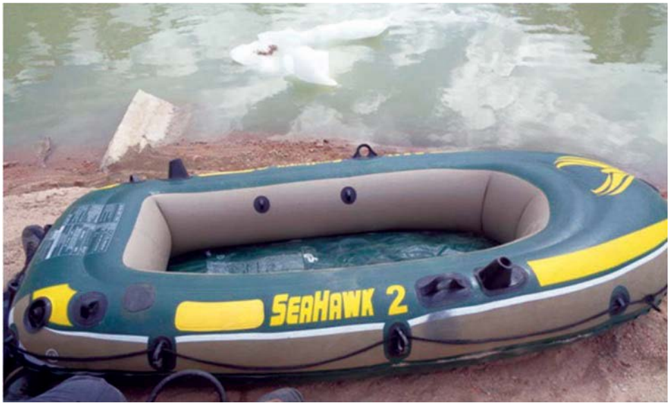
Рисунок 4.3 – Лодка для выполнения батиметрической съемки, масса 9 кг
