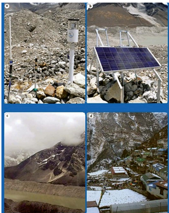
Рисунок 1.2 – Система мониторинга прорывоопасного озера Имджа: а – верхний полевой сервер на озере Имджа; б – солнечная панель полевого сервера; в – вид с верхнего полевого сервера на озеро; д – вид с нижнего полевого сервера на поселок Намче Базар
